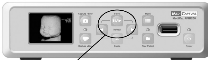
Die Auswahl- (Select), Zurück- und Weiter-Tasten dienen der Navigation durch die Menüs
