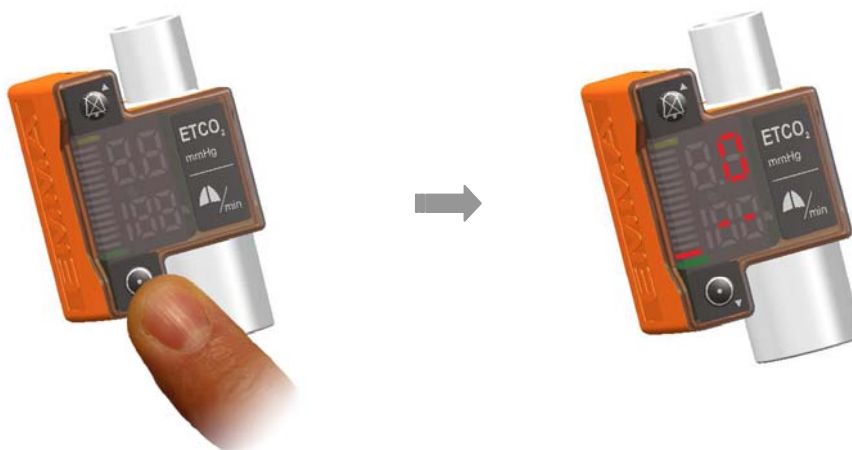
Abb. 6. Inbetriebnahme des EMMA Notfall-Kapnometers
