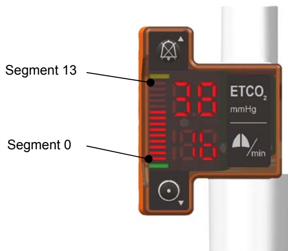
Abb. 10. EMMA Notfall-Kapnometer Monitor CO 2 Balkenanzeige
