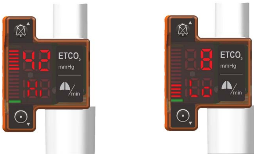
Abb. 11. Einstellen der High und Low ETCO 2 Alarmgrenzen
