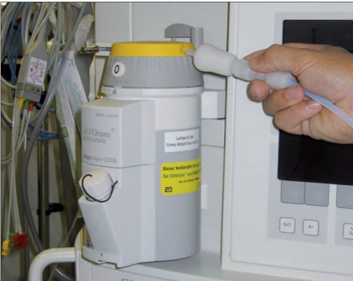
Dichtheitskontrolle beim Einstellrad des Vapor Dräger 2000
