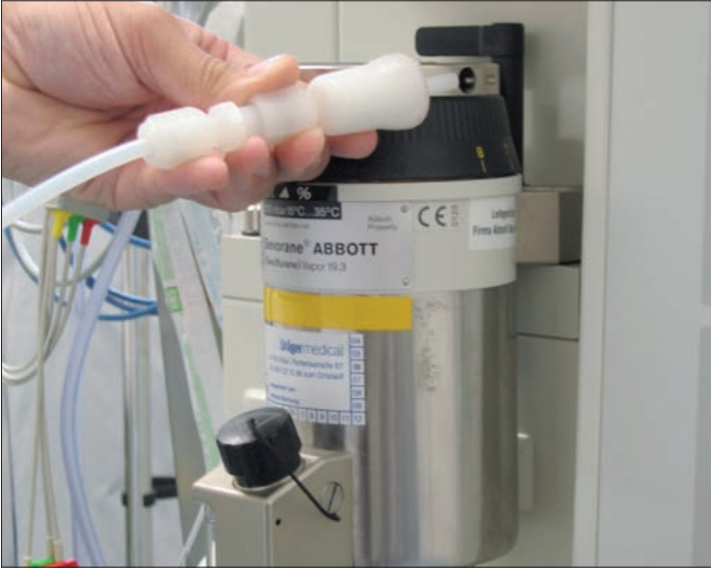
Dichtheitskontrolle beim Einstellrad des Vapor Dräger 19.3
